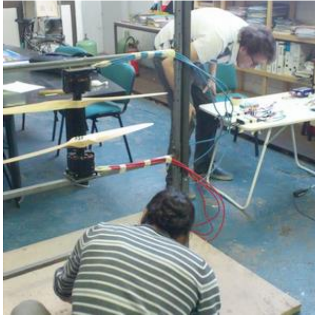
Fig. Le banc de test, les 2 hélices en bois, disposées en regard (mode 2) et les 2 gros moteurs CA120
