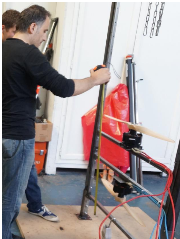
Fig. Nicola Munk et son équipe mesurant l'écart entre les 2 rotors sur le banc de test
