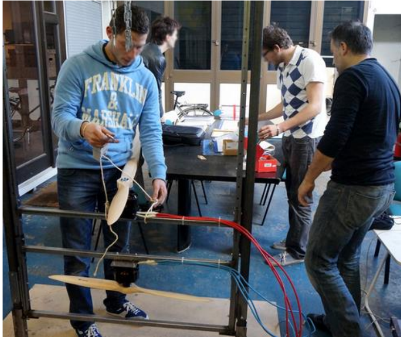
Fig. Le test avec la bonne disposition des hélices (mode 1) Les moteurs CA120 proches avec les hélices en opposition
