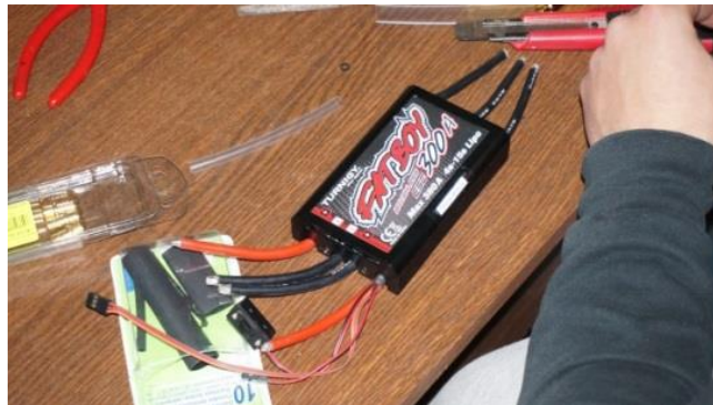
Fig. Un de nos ESC 300 ampères qui a grillé lors du test
