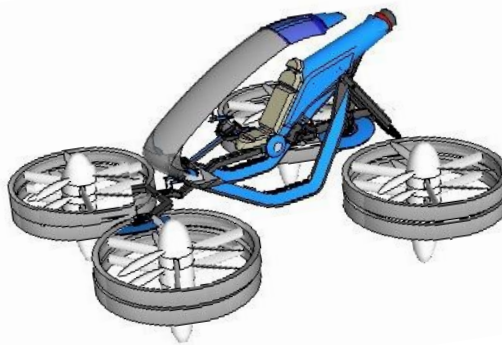
Fig. Une autre vision « plus fantaisiste » de l'engin « final » avec ses 4 turbines On note bien ici que chaque turbine est constituée de 2 hélices superposées qui tournent chacune dans un sens opposé
